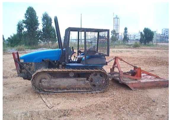
Tractor de lagartas equipado com destroçador ou corta-mato
